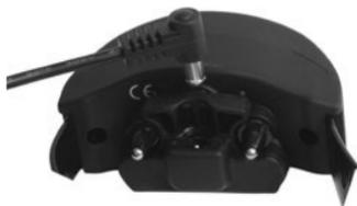
**Grazie alla tecnologia agli ioni di litio, il collare ricevitore si ricarica in sole 2 ore. Lasciare l'unità in carica oltre le 2 ore non provoca danni.**
