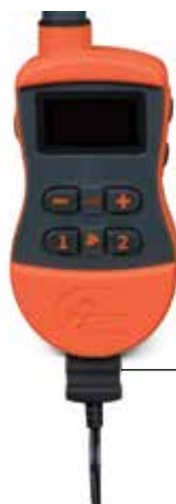
CONNECTEUR DU CHARGEUR BRANCHÉ À LA PRISE DE CHARGE DE L'ÉMETTEUR
