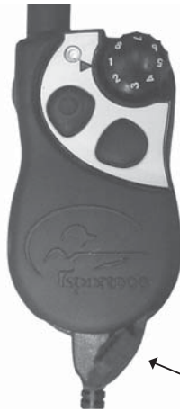
CONNETTORE DI RICARICA INSERITO NELLA PRESA DI CARICA DEL TRASMETTITORE A DISTANZA
