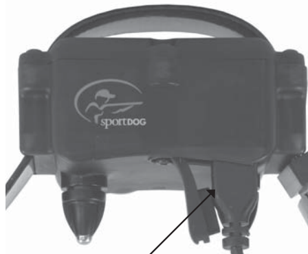
LADERTILSLUTNINGEN TILSLUTTET TIL HALSBÅNDSMODTAGEREN OPLADNINGJACK
