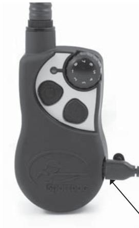
VERBINDINGSSTUK VOOR OPLADER GEPLAATST IN DE OPLAADSTEKKER VAN DE AFSTANZENDER
