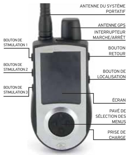
**SYSTÈME PORTATIF** : reçoit et affiche les changements de position du collier GPS. Il s'agit d'un dispositif étanche qui peut être immergé dans l'eau jusqu'à 1,5 m de profondeur.
