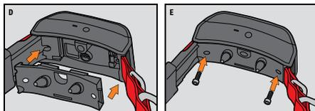
6. Remplacez les deux vis extérieures en faisant attention à ne pas trop les serrer (E).
